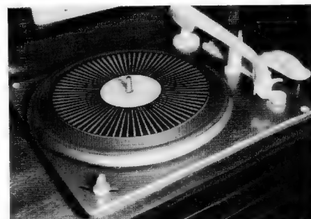
Bild 2. Drehzahlüberprüfung eines auf 78 Umdr./min. geschalteten Plattenspieler
